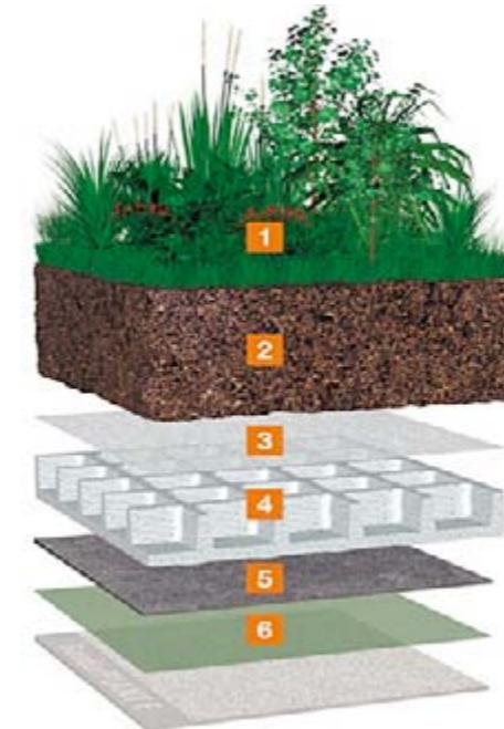
Slika 3: Slojevi u izgradnji intenzivnih zelenih krovova
